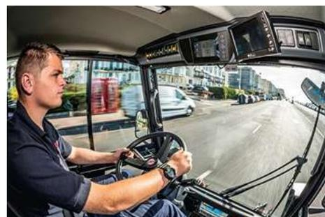
Todas las funciones de la unidad de baldeo se controlan a través del panel de control de la puerta con varios joysticks y pulsadores. La información más importante se puede ver de un vistazo en la pantalla en color de la consola del techo. Además, un mecánico puede realizar ajustes específicos de la máquina en la pantalla. Con la ayuda del sistema de diagnóstico de a bordo, se puede localizar cualquier fallo de forma rápida y eficaz.
