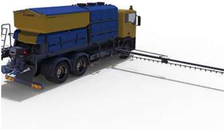
La solución ideal para los aeropuertos que desean una pulverización precisa y tienen menos presión de tiempo de deshielo.
