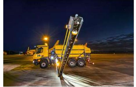
La sólida construcción en paralelogramo de la parte delantera de la máquina garantiza un guiado seguro de los brazos rociadores. Las secciones exteriores del brazo de pulverización están hechas de aluminio y están protegidos contra las colisiones mediante un sistema de seguridad.
