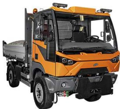
La **carga útil máxima** de **3800 kg** y el amplio equipamiento básico del MT 760 permiten su **uso diario** en todas las estaciones. El **peso total** es de **6500 kg**.
