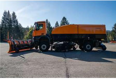
La CJS se monta de serie en el vehículo portador tipo chasis Mercedes-Benz Arcos 2036. Este vehículo de transporte tiene un diámetro de giro de 18 metros y ofrece la opción de dirección adicional del eje trasero para mejorar la agilidad. El equipamiento básico y las emisiones de gases de escape del vehículo portador deben seleccionarse específicamente para cumplir las normas del cliente y del país correspondiente.
