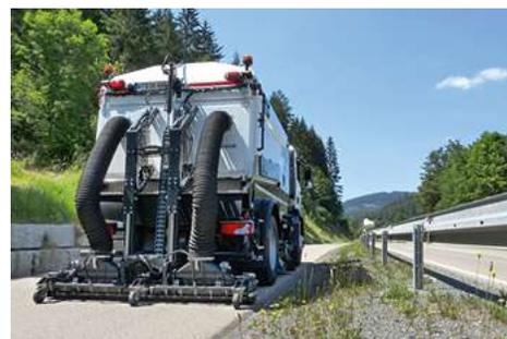
El desplazamiento transversal hacia la izquierda o hacia la derecha permite el ajuste lateral cuando se conduce en línea recta. De este modo, la unidad de aspiración trasera se puede situar más cerca del bordillo, además, la suspensión neumática correspondiente también sirve como protección lateral contra colisiones. La unidad de aspiración trasera no depende del tipo de camión. Su manejo está completamente integrado en el panel de control ES, lo que facilita el control durante la conducción.
