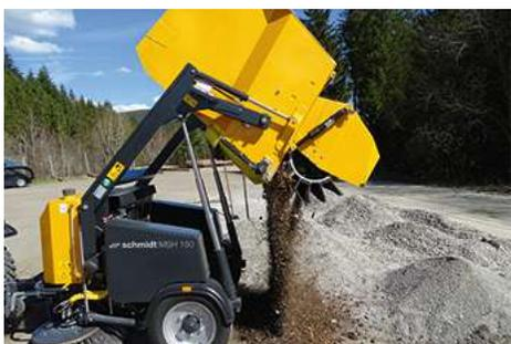
Las barredoras remolcadas MSH llevan una tolva de acero con una capacidad de 0,7 m<sup>3</sup> y 1,5 m<sup>3</sup> respectivamente. Las alturas de descarga son, respectivamente, 1.500 mm. y 1.800 mm. La tolva se inclina hidráulicamente hacia atrás.
