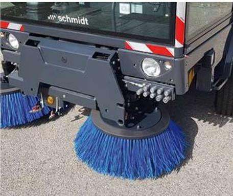
Un sistema flexible de barrido garantiza una limpieza impecable en cualquier situación. El sistema de cepillos, montado delante del eje delantero, tiene una anchura de barrido de 2.200 mm.
