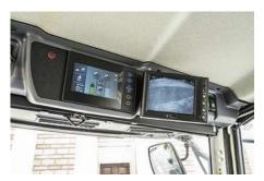
Die Kehreinheit wird über die Türbedienkonsole mit Joysticks und Drucktasten gesteuert. Mit der Auto-Drive Option können über den ergonomisch geformten multifunktionalen Fahrhebel alle Kehrfunktionen sowie die Fahrbefehle im Kehrmodus bequem bedient werden. Fahren und Kehren aus einer Hand bedeutet mehr Sicherheit und weniger Stress.
