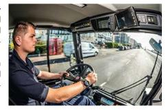
Die wichtigsten Informationen sind auf einen Blick auf dem Farbdisplay in der Dachkonsole sichtbar. Zusätzlich kann ein Mechaniker im Display maschinenspezifische Einstellungen vornehmen. Mithilfe des Onboard-Diagnose-Systems sind eventuelle Störungen schnell und effizient zu lokalisieren.
