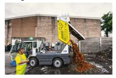
Der Kehrgutbehälter mit einem Systemvolumen von 2 m³ ermöglicht maximale Kehrgutaufnahme und einen grossen Aktionsradius. Der Kehrgutbehälter besteht aus korrosions- und seewasserbeständigem Aluminium. Eine grosse Auskipphöhe von 1400 mm ermöglicht das Entleeren in alle gängigen Schmutzcontainer. Optional ist das Saugrohr im Behälter aus verschleissfestem Edelstahl verfügbar.
