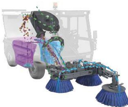
El sistema de 3 cepillos, con el tercero instalado en un brazo de movimiento libre, ofrece una anchura de barrido de hasta 2.600 mm. Es posible alinear el cepillo delantero a la derecha o a la izquierda, así como barrer en dos niveles o usar un cepillo desbrozador.
