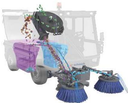
El sistema de 2 cepillos, con sus cepillos controlables independientemente, garantiza una movilidad absoluta en todas las situaciones de barrido. Los dos firmes brazos del cepillo, con amortiguadores integrados, ofrecen una anchura de barrido de hasta 2.900 mm.
