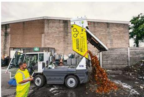
Una tolva con una capacidad de 2 m<sup>3</sup> permite un máximo rendimiento de barrido en un gran radio de acción. La tolva está hecha de aluminio resistente a la corrosión y al agua de mar. Su gran altura de descarga, de 1400 mm, permite vaciar en todos los contenedores para desechos habituales. Opcionalmente, hay disponible un tubo de aspiración para la tolva de acero inoxidable resistente al desgaste.
