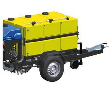
El CSP A 1000 tiene un tanque de salmuera con una capacidad de 1000 l.
