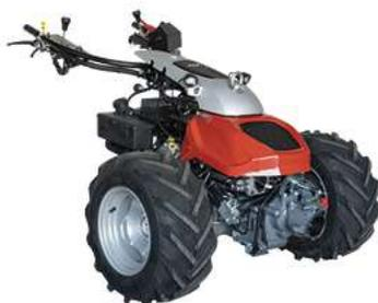
La CC 160 está equipada con un motor de gasolina de dos cilindros con inyección electrónica de **23 CV**. La velocidad de marcha puede adaptarse ergonómicamente a las distintas necesidades con el nuevo TipTronic de diez etapas.
