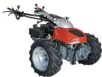
La CC 150 está propulsada por un motor de gasolina de dos cilindros con **18 CV**. Su diseño compacto permite trabajar en espacios reducidos y también acoplar accesorios de mayor tamaño sin comprometer la demanda de potencia.
