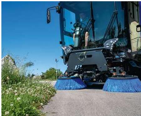
Un sistema di spazzamento flessibile assicura una pulizia accurata in ogni situazione. Completamente montato, consente una larghezza di spazzamento di 2.200 mm.
