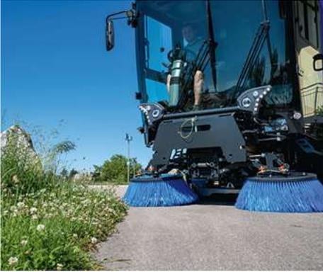
Un sistema de barrido flexible que garantiza un resultado de limpieza óptimo en cualquier situación. El sistema de cepillos cilíndricos de tracción, montado delante del eje delantero, tiene una anchura de barrido de 2 200 mm.
