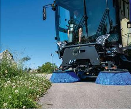
Un sistema de barrido flexible que garantiza un resultado de limpieza óptimo en cualquier situación. El sistema de cepillos cilíndricos de tracción, montado delante del eje delantero, tiene una anchura de barrido de 2 200 mm.
