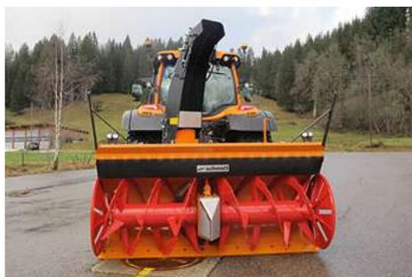
Los tambores de corte con espirales de corte abierto garantizan un transporte óptimo de la nieve a la turbina gracias a los cuchillos de corte que se ensanchan hacia el interior. Los aros situados en tambores de corte aseguran una sujeción estable y, en combinación con los cuchillos laterales se garantiza una muy buena maniobrabilidad del vehículo portador. Los tambores de corte se accionan mediante un robusto engranaje cónico central y están protegidos por embragues autorregulables.
