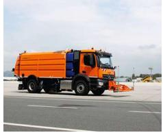
Barredora de alto rendimiento especialmente diseñada para las necesidades de las áreas de tráfico de los aeropuertos.
