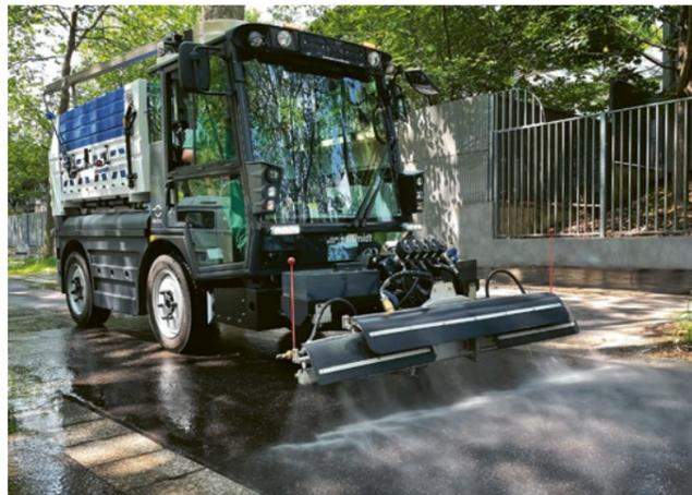
Das vollelektrische Schwemmfahrzeug Schmidt eCityJet 3030 bietet unter heissen, trockenen und sehr staubigen Bedingungen eine interessante Alternative zur Kehrmaschine. (Bild oben)
