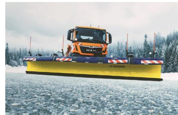
Der Schmidt Tarron HP-2W Schneepflug hat bei einem Anstellwinkel von 30° eine Arbeitsbreite von über 6 m. (Bild oben)
